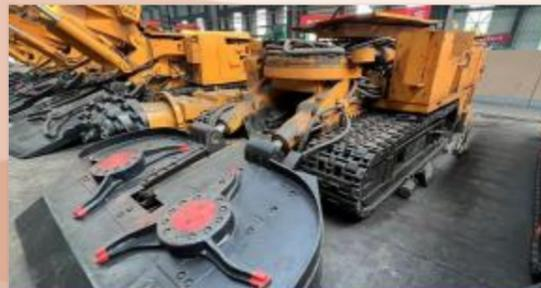
Секция пластины лопаты, соединенная с корпусом
